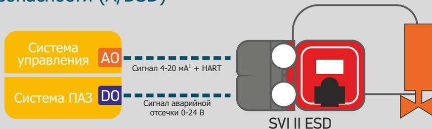
Четырехпроводное решение. Функция безопасности реализована слежением за напряжением сигнала 0-24 В (пример: 0 В = безопасное положение)
