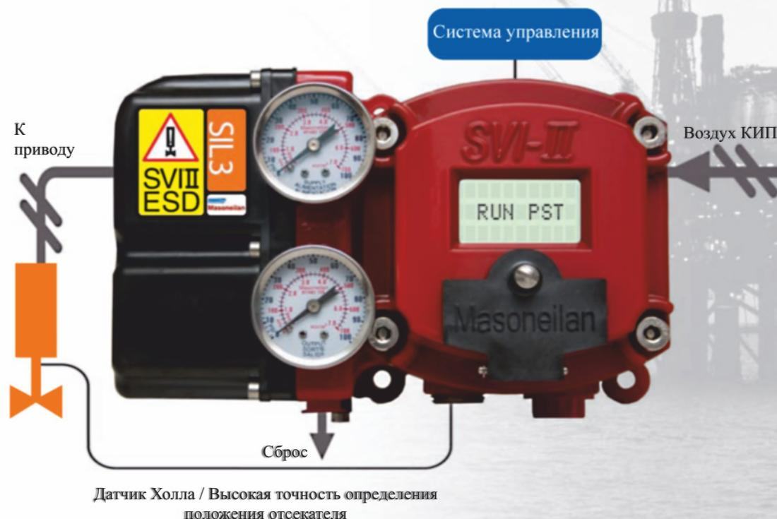
SVI II ESD спроектирован таким образом, что функция обеспечения безопасности абсолютно независима от функции PST. Встроенная система, выполняющая аварийную отсечку, не зависит от встроенного микропроцессора. Это позволяет позиционеру обеспечивать высокий уровень функциональности, оставаясь простым устройством Типа А.
