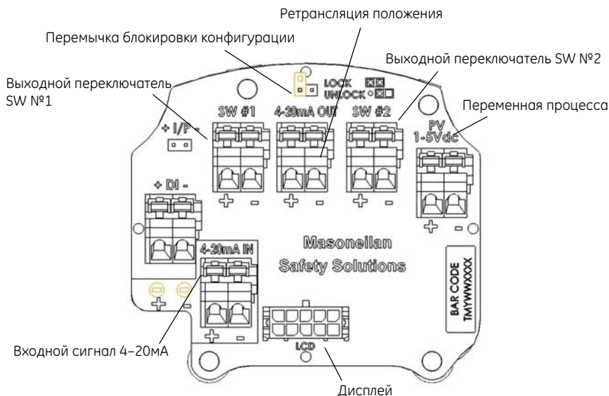
Рисунок 15 Разъемы для подключения к блоку электроники ASD (через клеммную панель)
